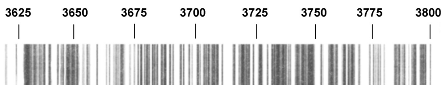
Рис. 24.3. Участок спектра железной дуги
